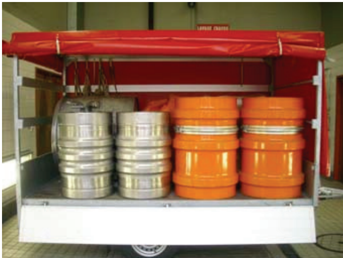
2 fûts de confinement acier (fûts orange) 2 fûts inox 200 litres
